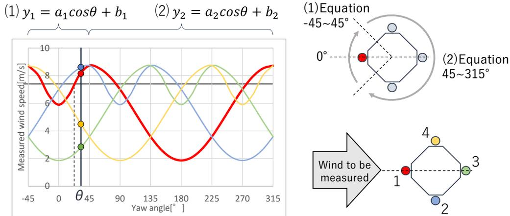
Fig 8. 【Calculation Method I】 cos curve-fitting
